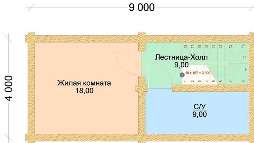
Данный проект может быть выполнен из оцилиндрованного бревна диаметром от 20 до 28 см или клееного бруса различных сечений.
