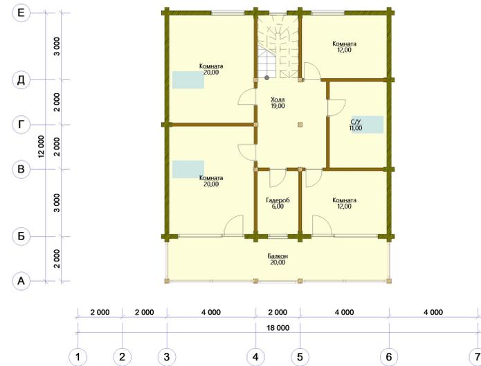
Данный проект может быть выполнен из оцилиндрованного бревна диаметром от 20 до 28 см или клееного бруса различных сечений.
