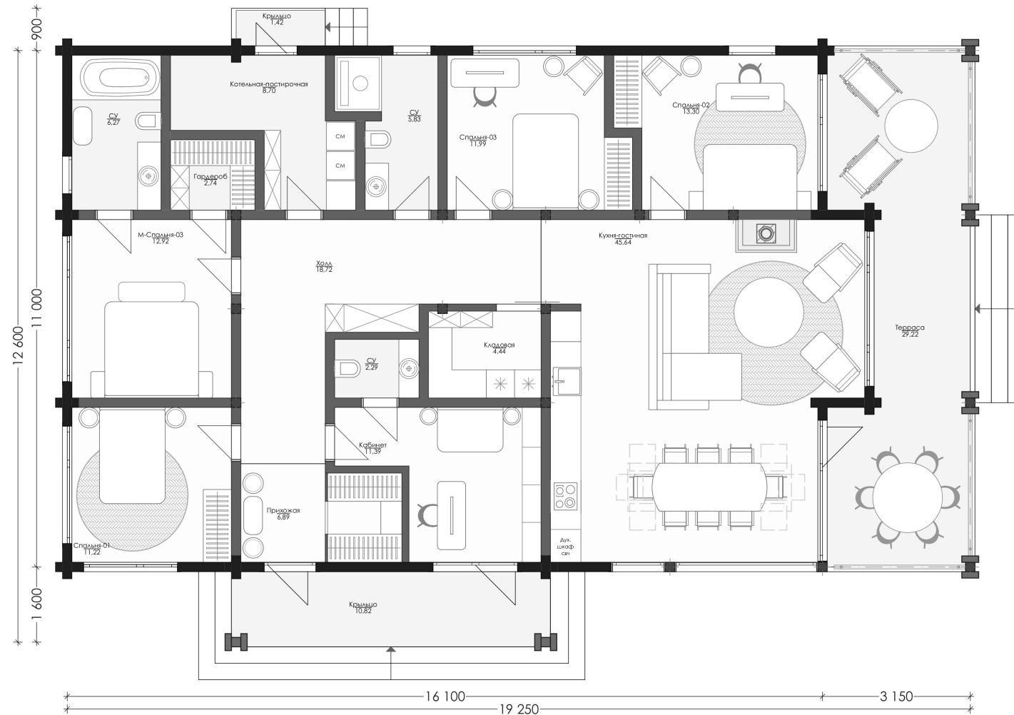
Данный проект может быть выполнен из оцилиндрованного бревна диаметром от 20 до 28 см или клееного бруса различных сечений.
